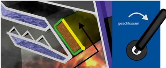
In der Anheizphase wird der Katalysator durch die Bypassklappe geschützt. Die kalten Abgase werden somit am Katalysator vorbei geleitet.
